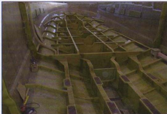
nella fase costruttiva: percentuale di fibra di rinforzo, spessore e caratteristiche meccaniche del laminato. Il prodotto è più omogeneo e sicuro; infatti si eliminano tutte le imperfezioni e le problematiche dovute ad una laminazione manuale [fig. 7].
